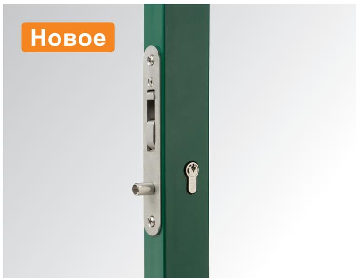
Врезной замок, выполненный на 100% из нержавеющей стали, с крюком для механического запираения (автоматических) раздвижных ворот. Отверстие для ручки - а значит, ручка - отсутствует для предотвращения использования её как ступеньки при перелезании через забор. Анти-саботажный штырь может легко быть снят для использования замка в распашных типах ворот.
